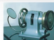
杯突测试 Eichsen test
